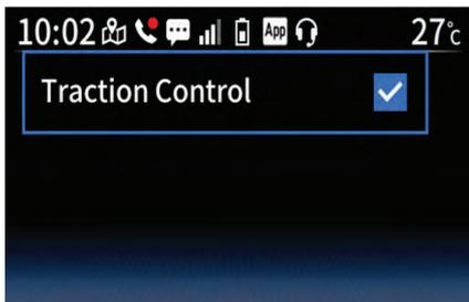
Pulse brevemente el interruptor “✓” para activar/desactivar el sistema de control de tracción. La marca de verificación indica ON. Para obtener más información sobre el sistema de control de tracción, consulte la página 5-23.
