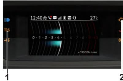
1. Indicador del sistema de control de tracción “TCS”
