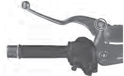
Los puntos de pivote de las manetas del freno delantero y trasero deben engrasarse esporádicamente según los intervalos especificados en el cuadro de mantenimiento periódico y engrase.
